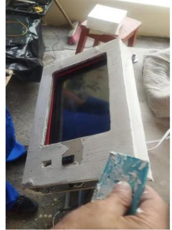
**Fig. 40: Ensamble de la carcasa de la Tablet. Fuente: Autores**
