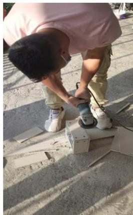
**Fig. 30: corte y ensamble del colimador. Fuente: Autores.**
