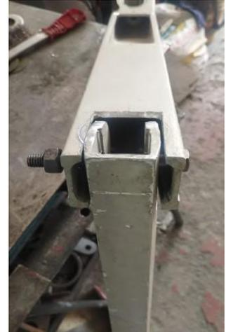
**Fig. 34: Mecanismo de apertura y cierre del brazo.** Fuente: Autores.
