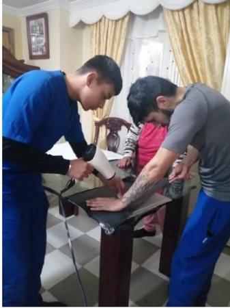
**Fig. 61: Proceso de corte y pegue de vinilo de fibra de carbono. Fuente: Autores**
